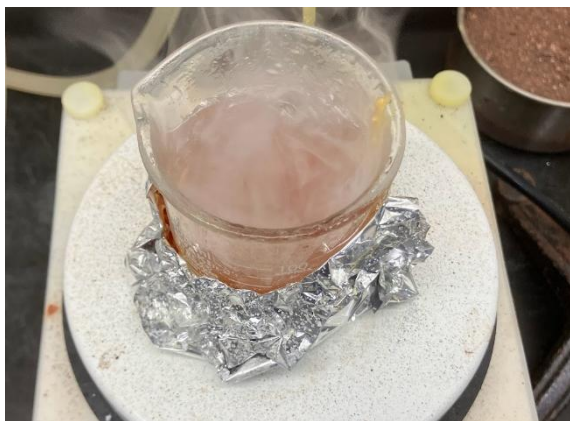
210℃で加熱攪拌中の様子。アミドの形成に伴って発生した水が蒸発している。
