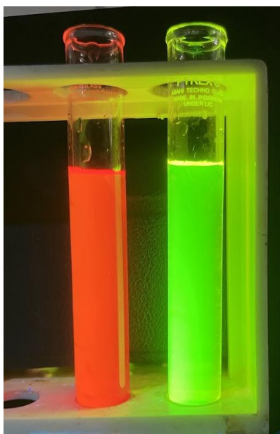
左はローダミン B、右はフルオレセインナトリウムの、ブラックライトによる蛍光
